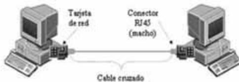
Figura 8: La conexión de sólo dos PCs (sin hubs) se deberá realizar mediante un cable cruzado
